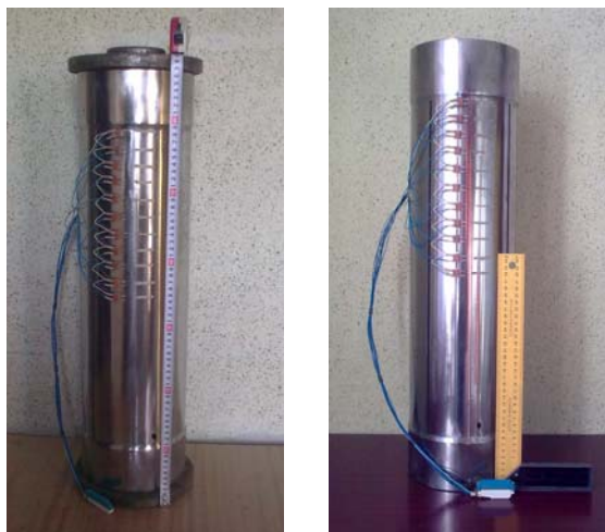
Рис. 3. Зразки об'єктів дослідження з наклеєними тензодавачами
