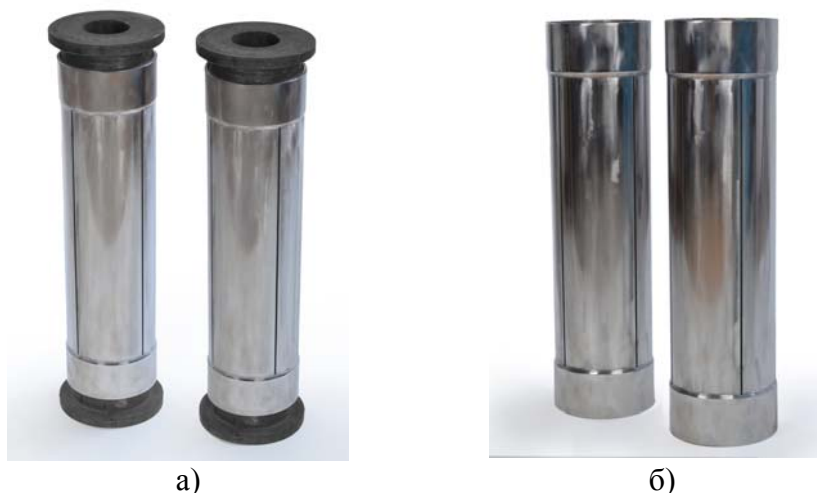
Рис. 2. Зразки об'єктів дослідження: а – лабораторний зразок оболонкової пружини; б – прорізна циліндрична оболонка
