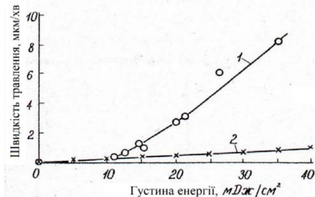
Рис. 6. Залежність швидкості травлення GaAs (100) в потоці HBr (665 Па) від інтенсивності випромінювання ексимерного лазера ( \lambda = 193 нм), орієнтованого перпендикулярно (крива 1) і паралельно (крива 2) до поверхні підкладки з температурою 333 К
