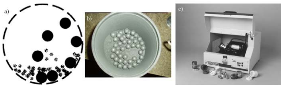
Рис.4. а) – Схематичне зображення кулькового млина; б) – кульковий млин із завантаженим матеріалом для подрібнення; с) – зовнішній вигляд лабораторного кулькового млина [24]
