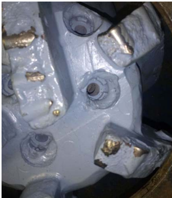
Рис. 1. Ерозія корпусу долота поблизу промивних отворів
