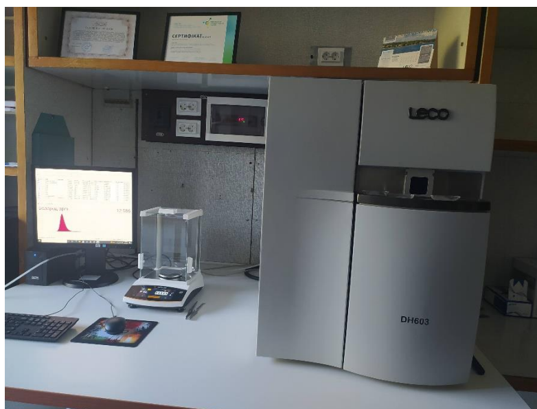
Рис. 1. Аналізатор дифузійно-рухомого і залишкового водню LECO DH603
