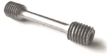
Рис. 2. Геометричні параметри та загальний вигляд зразків для випробувань на розтяг
