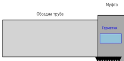
Рис. 1. Схематична модель різьбового з'єднання обсадної колони з нанесеним анаеробним герметиком
