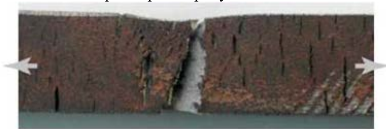
Рис. 1. Взірець охрупчення сталі після випробування на розтяг
