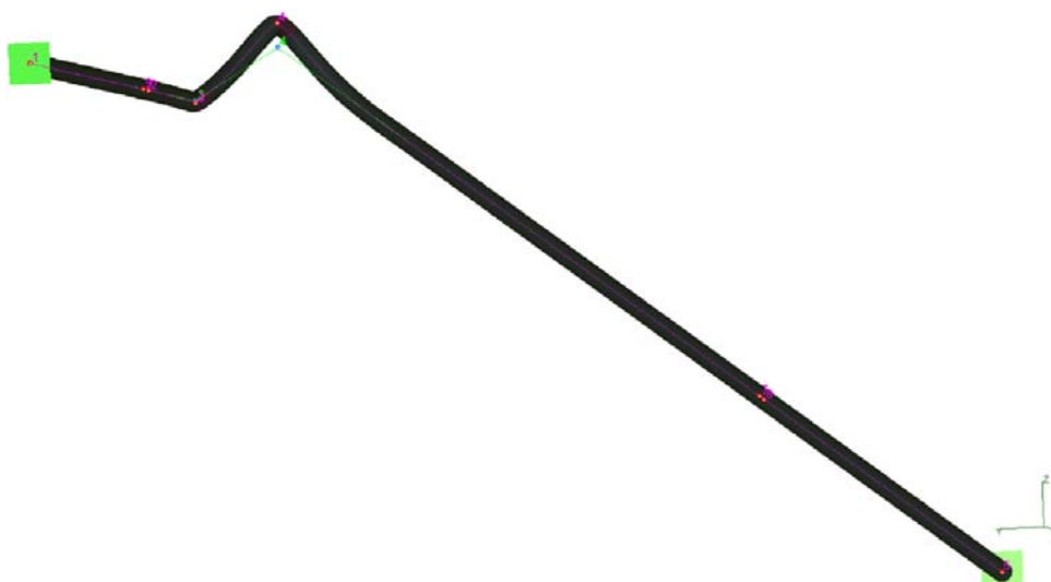
Рис. 2. Переміщення трубопроводу внаслідок його розкриття
