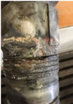
Рис. 4. Фрагмент зруйнованих пробок
