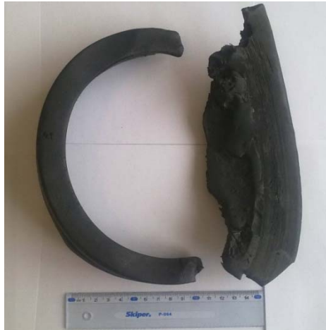
Рис. 3. Фрагмент зруйнованої протискувальної пробки
