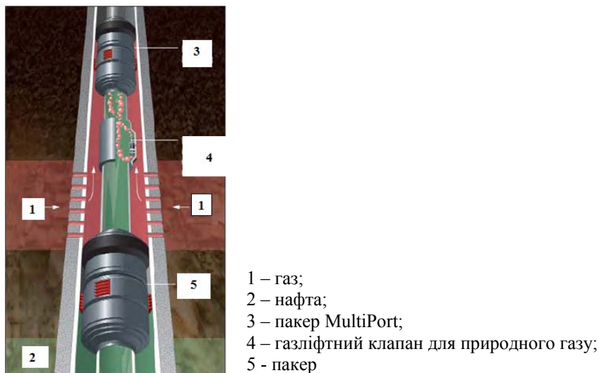
Рис. 1. Схема безкомпресорного газліфта
