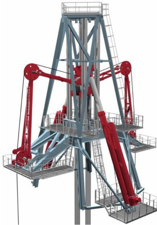
Рис. 12. Конструкція компенсатора з похилими гідроциліндрами (Aker Solutions)
