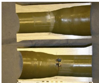
Рис. 2. Промивина і втомна тріщина при внутрішньому руйнуванню [4]
