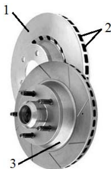
Рис. 2 Самовентильовані диски: 1, 2 – диск с вентиляючими каналами; 3 – фланец
