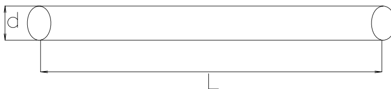
Рис. 1. Капіляр радіусу r довжиною L в гірській породі
