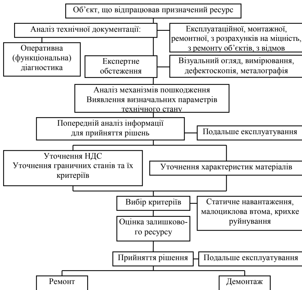
Рис. 3. Структурна схема оцінювання залишкового ресурсу нафтогазопроводу
