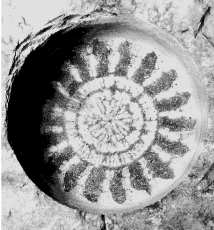
Рис. 1. Поверхня вибою свердловини під час буріння долотом 93Т в пісковнику воротищенської світи твердістю p_{\text{ш}}=1440\text{МПа} , число зубців периферійної рейки – 18
